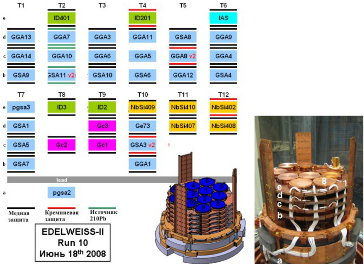
Рис. 4.1. Фотография, схема сборки детекторов внутри криостата и их местоположение.
