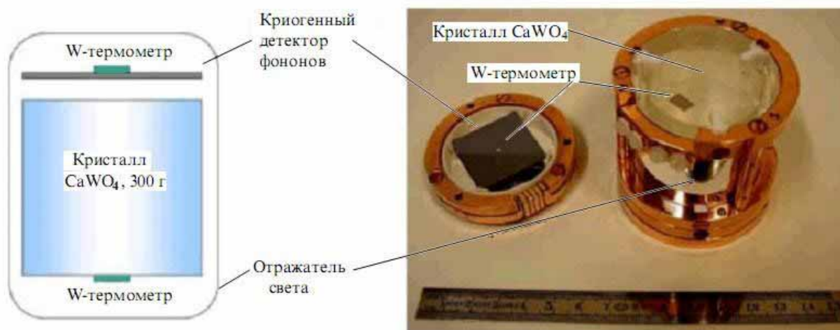
Рис. 1.26. Схема и фотография детектора CRESST-II [Rya08]. W- термометр – вольфрамовый термометр.
