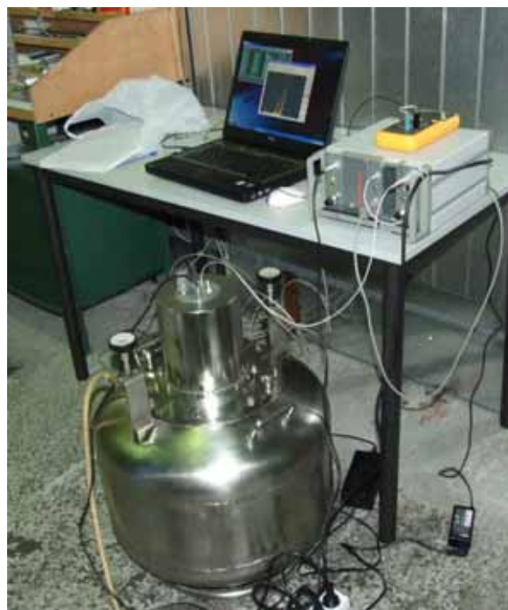
Рис. 3.2. Принципиальная схема (слева) радонового детектора и его внешний вид с электроникой (справа).
