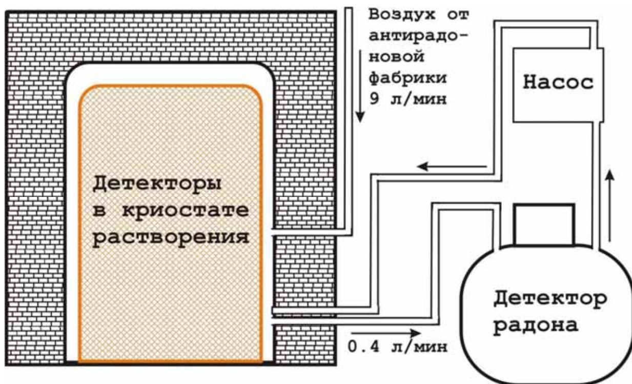
Рис. 3.7. Схема детектирования и постоянного контроля над содержанием радона в EDELWEISS.
